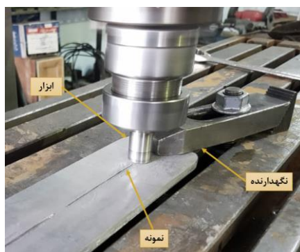
شکل ۲- موقعیت قرارگیری ابزار، نمونه و نگهدارنده در دستگاه فرز، آماده جهت فرایند اصطکاکی اغتشاشی
