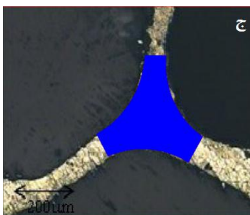
شکل ۱۰- مراحل بدست آوردن منطقه پلاتو با کمک نرم افزار اتوکد.
