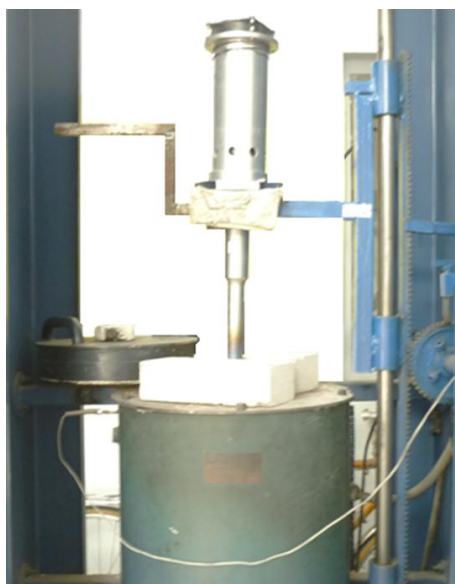
شکل ۳- دستگاه آلتراسونیک استفاده شده برای پخش نانو ذرات در مذاب.
