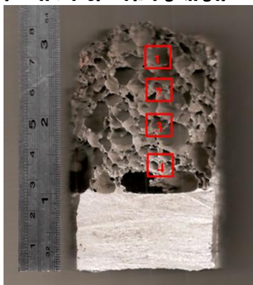
شکل ۹- تصویر ماکروسکوپی از مقطع طولی فوم ریخته‌گری شده به روش ذوبی.
